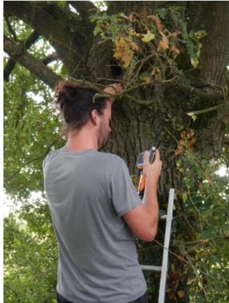
**Figure 4 : Examen d'une cavité à l'aide d'un endoscope**
